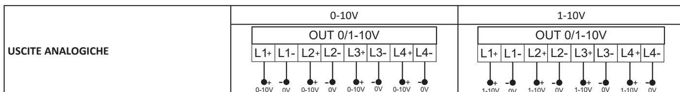
Le 4 uscite analogiche sono del tipo Sink / Source e sono in grado di comandare sia dispositivi con comando 0-10V sia dispositivi con comando 1-10V.
