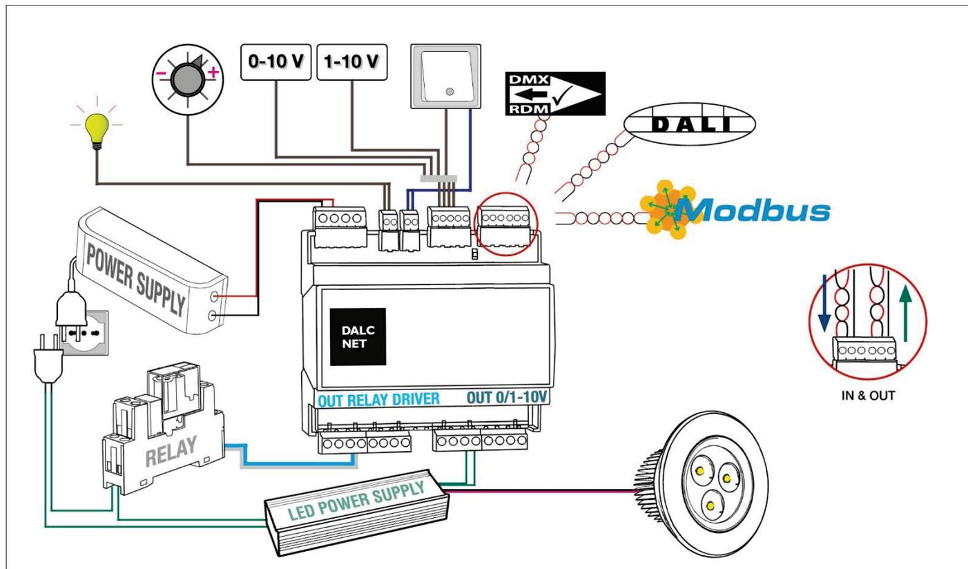
Grazie al DIM CONVERTER è possibile comandare degli alimentatori con funzione DIMMING (con ingresso di comando 0/1-10V) per poter dimmerare il carico ad esso collegato.
