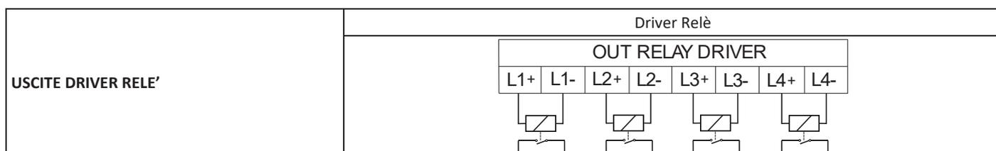
Le 4 uscite digitali sono uscite "Driver Relè" e sono in grado di comandare dei relè di potenza.
